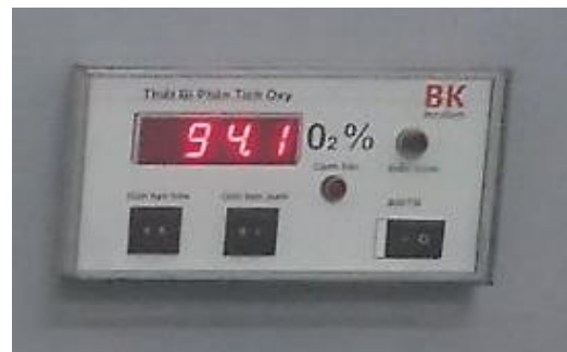
Hình 8: Kết quả đo độ tinh khiết Oxy trên thiết bị phân tích Oxy sau 10 chu trình làm việc
