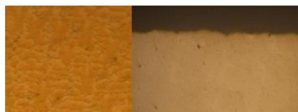
Hình 3.2: Ảnh kim tương bề mặt và mặt cắt ngang của mẫu kim loại nhôm sau 1 lần nhúng phủ (độ phóng đại 200 lần và 500 lần)
