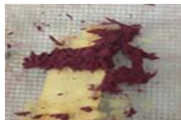
Hình 1: Hình ảnh sản phẩm bột mịn màu nâu đỏ \text{Cu}_2\text{O}-(\text{SO}_4^{2-})
