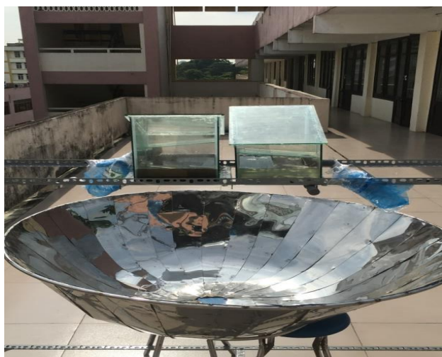
Hình 14: Chuẩn bị thử nghiệm đánh giá khả năng thu hồi nước ngọt
